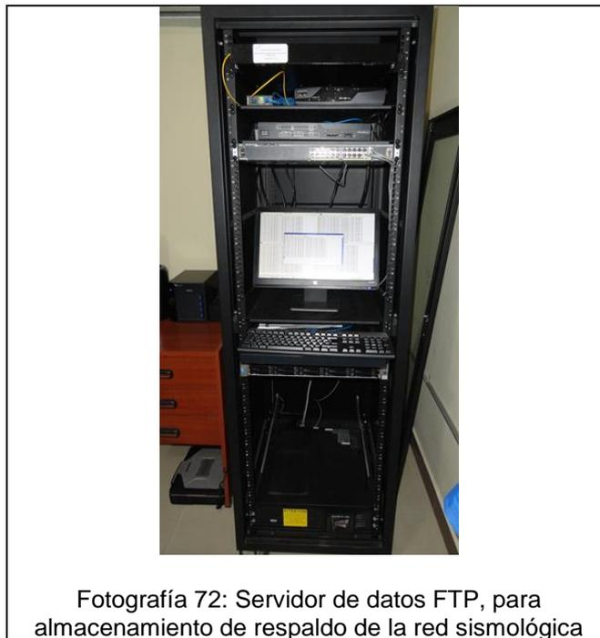
Fotografía 72: Servidor de datos FTP, para almacenamiento de respaldo de la red sismológica
