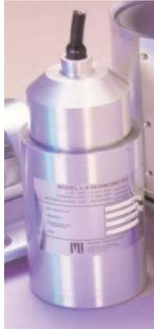
Fotografía 37: Sensor de velocidad modelo L4C
