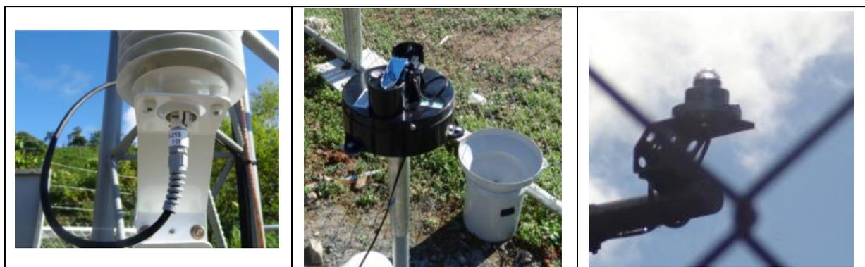
Fotografía 26: Sensor de temperatura y humedad – Sensor de lluvia – Sensor de radiación.
