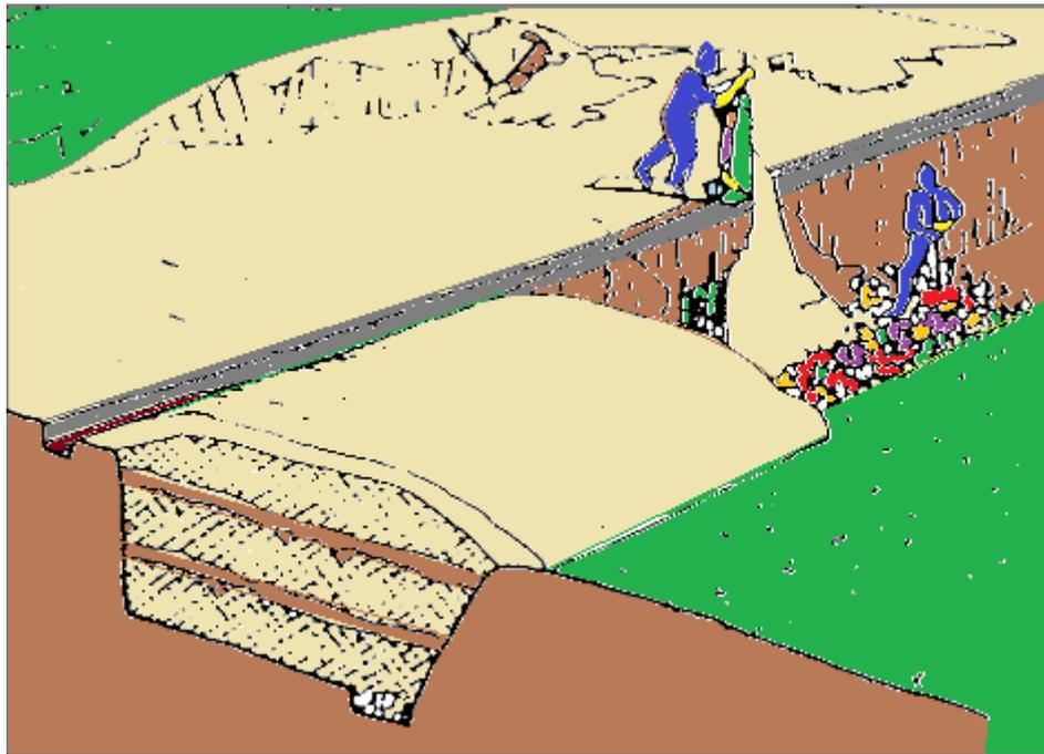
Figura 73: Conformación final del relleno sanitario.
