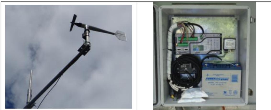
Fotografía 29: Sensor de velocidad y dirección del viento, pararrayos – Data logger y barómetro.
