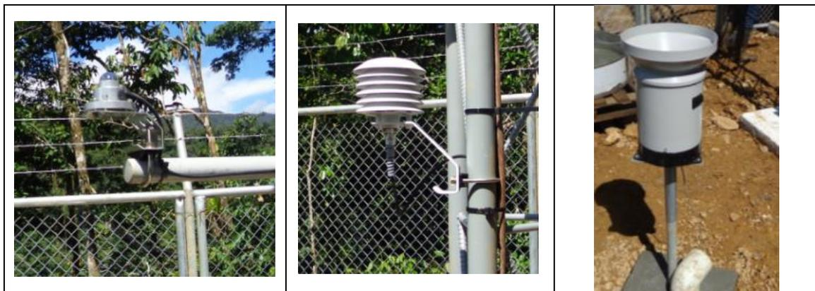
Fotografía 34: Sensor de radiación - Sensor de temperatura y humedad – Sensor de lluvia.
