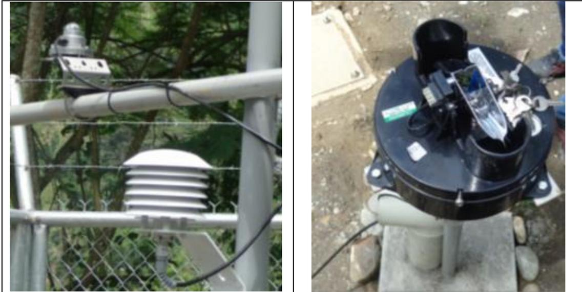
Fotografía 30: Sensor de radiación - Sensor de temperatura y humedad – Sensor de lluvia.
