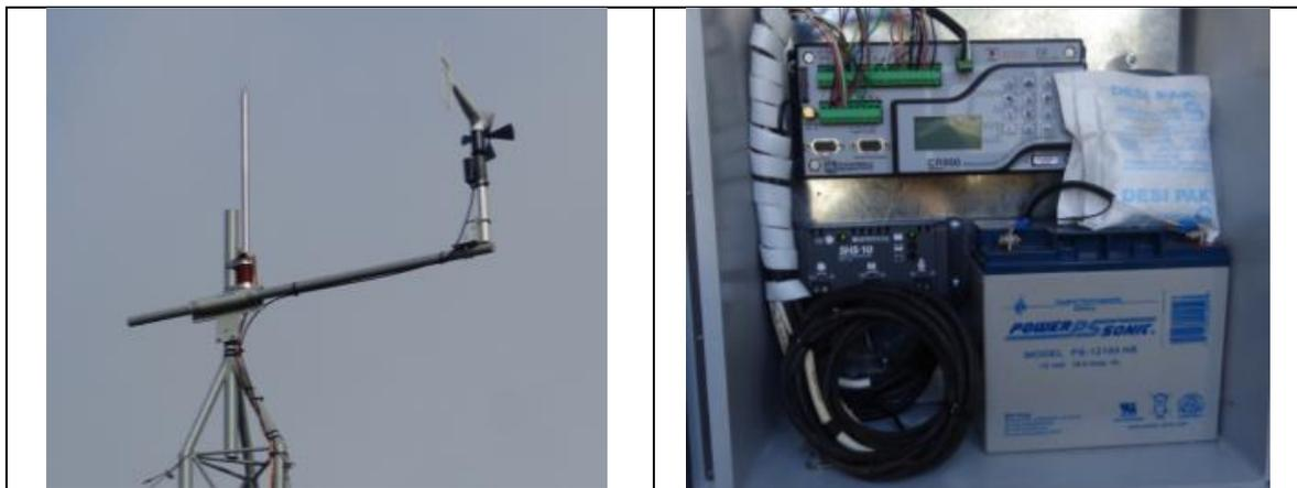
Fotografía 25: Sensor de velocidad y dirección del viento, pararrayos – Data logger y barómetro
