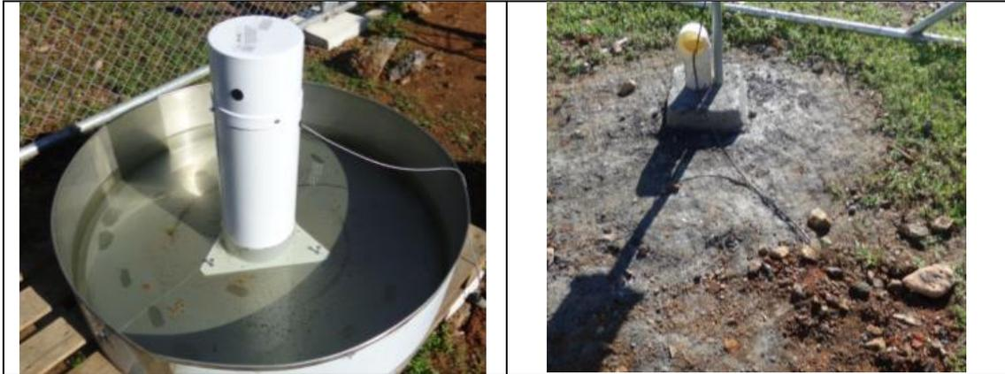
Fotografía 27: Sensor de evaporación – Sensor de temperatura y humedad del suelo.
