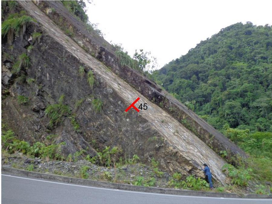
Fotografía 5.3- 1: Afloramiento de calizas y areniscas calcáreas con intercalaciones de limolitas, pertenecientes a la Formación Santiago, al oriente del poblado de Palominos. La estratificación tiene un rumbo N10°W y buzamiento de 45° al NE.
