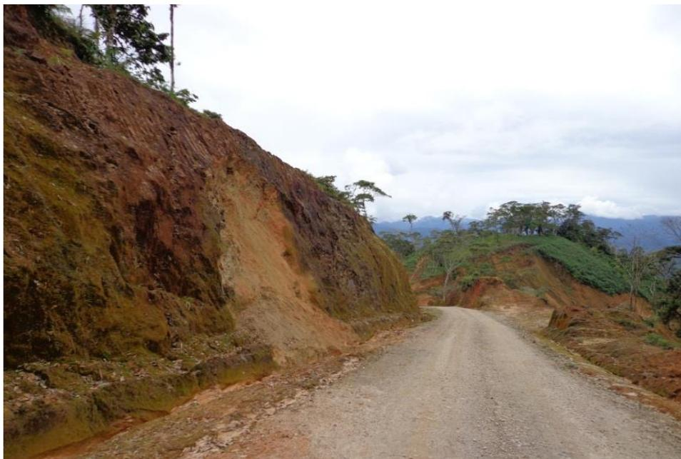
Fotografía 5.3- 7: Alteración que suele presentar el Batolito Zamora con sus coloraciones pardas y rojizas producto de las alteraciones de los minerales ferromagnesianos.
